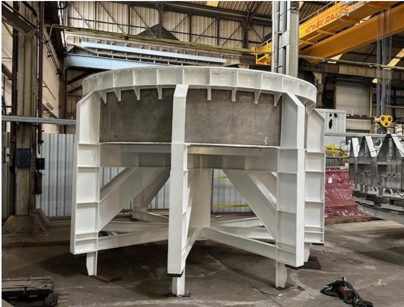
Afdichtingsvoorziening van de reactorput
